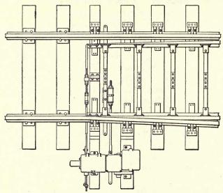
FIG. 138 .- Style "M" switch layout.
